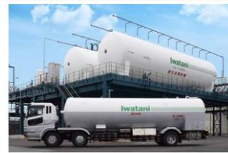
タンクローリー車と大型液化水素貯槽
