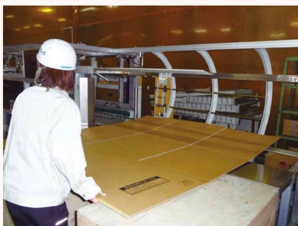
スルー式エコ・ステッチャー。大形ダンボールでも、女性が簡単に縫い合わせることができる
