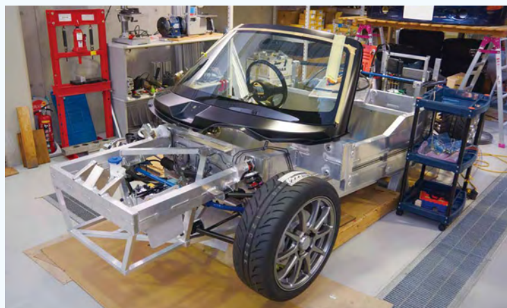
アルミを溶接した骨組みで軽量化を図った
