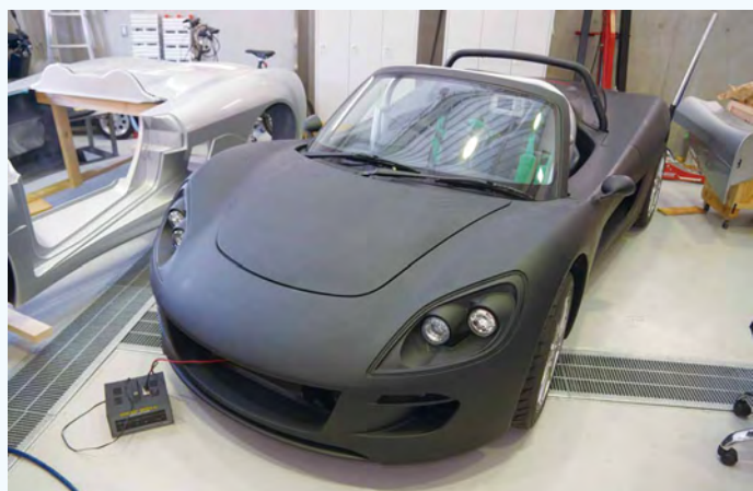
FRP製のカウルは、金型では抜き出せない滑らかな形状を持つ
