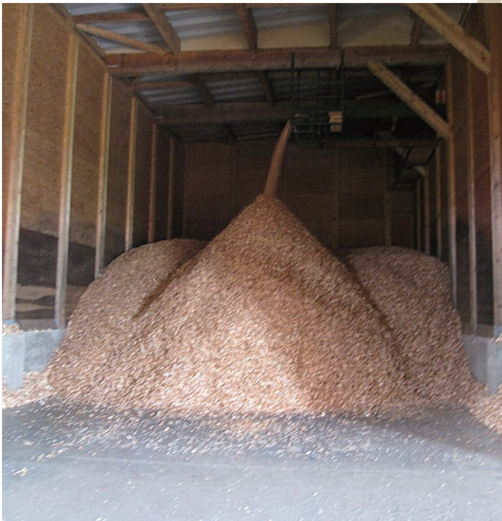
⑤規定の大きさに破砕されたチップの山。さまざまな紙の原料となる
