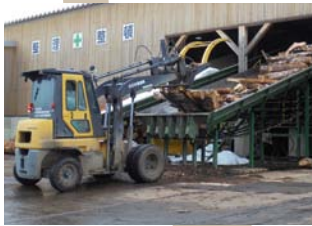
③ベルトコンベアでチップ工場内に
