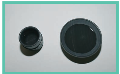
エンドミル(工具)による切削 完成
