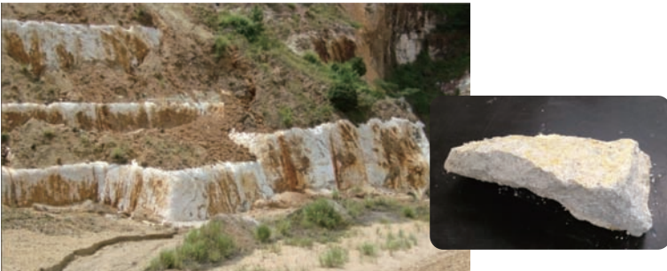
粘土地層から掘り出され、固形（右）を下図の生産工程で粉砕、水篩などを経たあと沈壽官窯で焼いて硫化鉄を抜き、ようやく原料土になる
