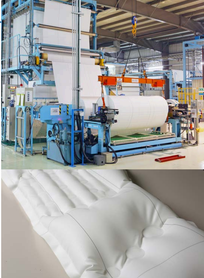
上段の写真：サイドカーテンエアバッグの製造。ナイロン繊維の袋にシリコン樹脂がコーティングされている
