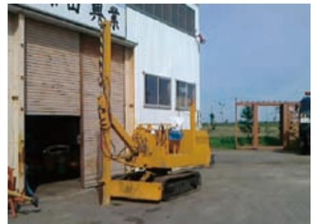
試作品①(薬液注入用穿孔機械)
