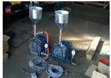
試作品②(薬液注入用圧力ポンプ)
