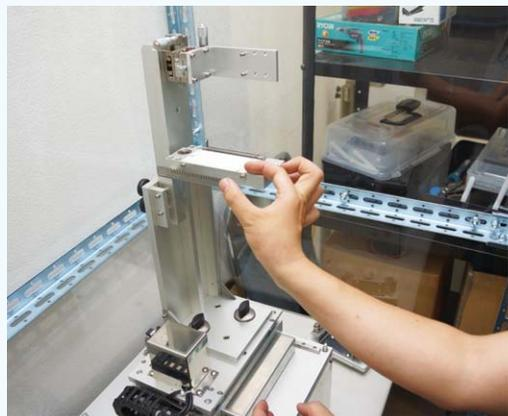
台のギザギザに合わせて針金のリングを乗せる。一度に20本のリングをレーザーで溶接することができる
