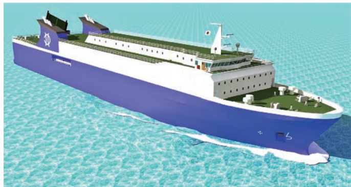
来年就航する『HAKKO ひなた』の完成イメージ図。全長121メートル、幅16.7メートル、総トン数2,242トンの「はっこう21」から全長134メートル、幅21メートル、総トン数4,999トンに大幅スケールアップ。貨物の温度管理などに使われる電源も増強される
