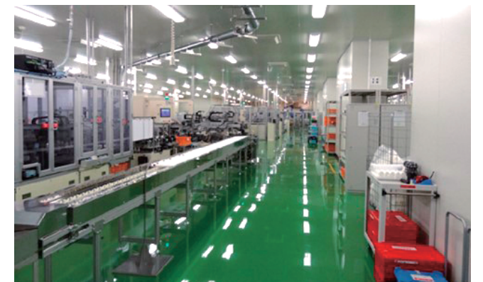
ダイアライザの自動組み立てライン
