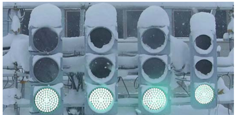
《透明ヒーターの融雪試験状況》
