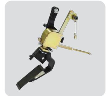
ペダル踏み間違いによる事故を防ぐ車両用ペダル装置の開発
