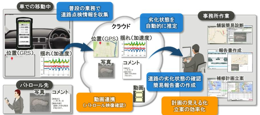
【道路舗装維持管理システム(道路見守りパトロール：道パトによる劣化度推定の一例)】
