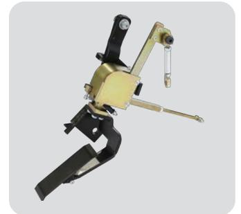
ペダル踏み間違いによる事故を防ぐ車両用ペダル装置の開発（岡山県美作市）
