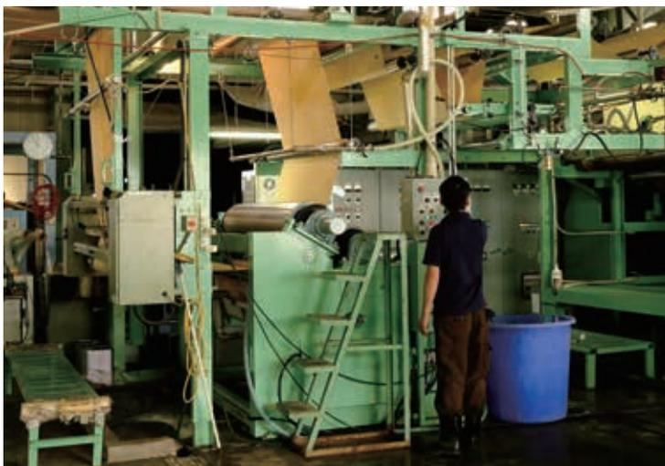
MVA 加工を行うため従来の加工機械を改造した
