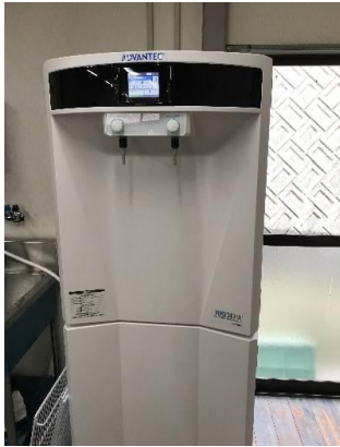
《RO 水・蒸留水生成装置》
