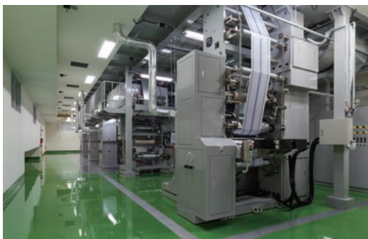
第2工場には繊細なアルミ箔にグラビア印刷やコーティングなどを行う最新鋭の機械が並び
