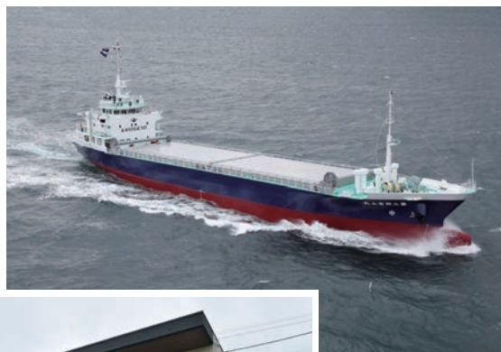
499 総トンの第二舩宝山丸。船倉を分けることで2種類の穀物などを同時に積載できる
