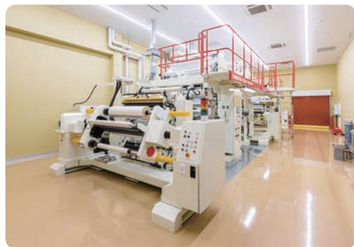
従来の印刷に比べ大幅に環境負荷を低減する水性フレキシ印刷機（上）。下は接着剤に有機溶剤を使用しないノンソルベントラミネーター
