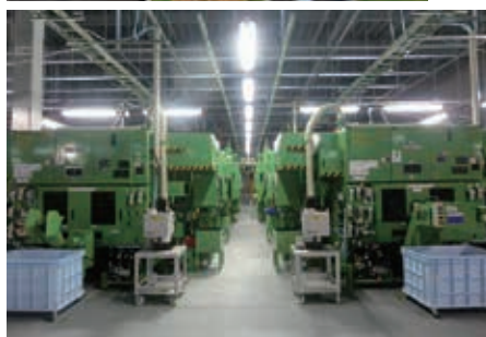
BCP(事業継続計画)の観点も加味して進出した鳥取工場全景(上)。広い工場内には最先端の5軸切削加工の設備などが並ぶ
