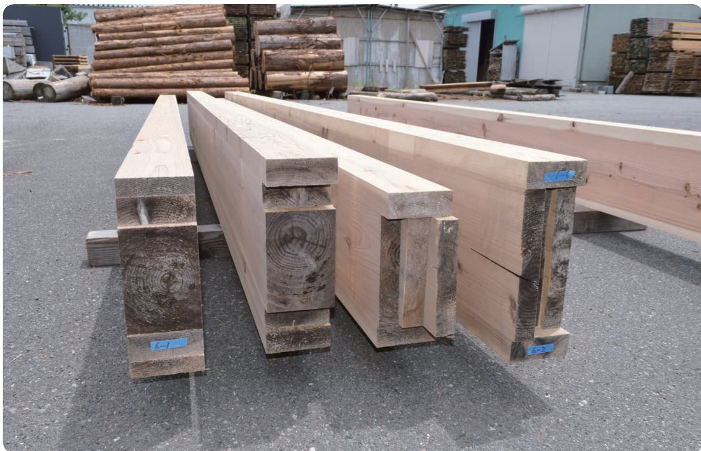
さまざまな組み合わせでつくられた「重ね梁」の試作品。曲げ強度試験で上下の材の強度が全体の強度に大きく影響することが分かった
