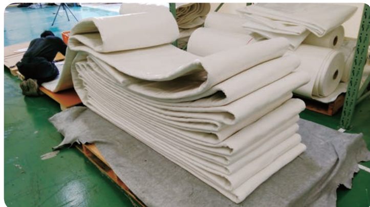
製造されたライニング材。ポリエステルやグラスファイバーの不織布にポリエステル樹脂やビニールエステル樹脂を含ませるが、個々の管の状況に合わせて製造される
