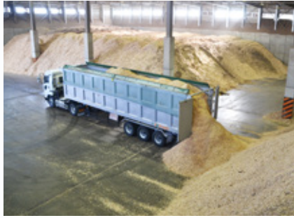
発電に適しているのは切削した木質チップ。「破碎したチップは細長い形状のため、搬送設備で詰まってしまうことがあります」(長谷川氏)
