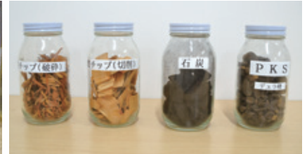
発電に適しているのは切削した木質チップ。「破碎したチップは細長い形状のため、搬送設備で詰まってしまうことがあります」(長谷川氏)
