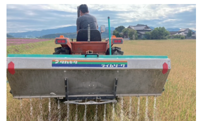
（上）行き場を失った石膏型の山。（下）廃石膏の農業用肥料散布の様子。町職員自ら実験の実務を担った。
