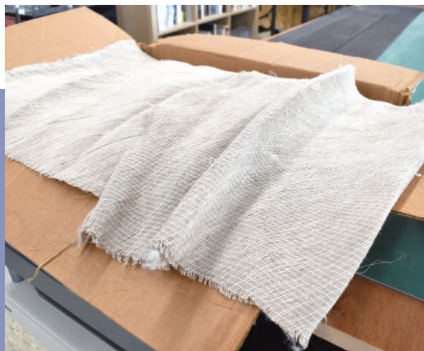
ガラス繊維の代用として採用された亜麻繊維。編み方も調整し、スキー板・スノーボードの使用に適した耐久性としなりのある素材になっている。
