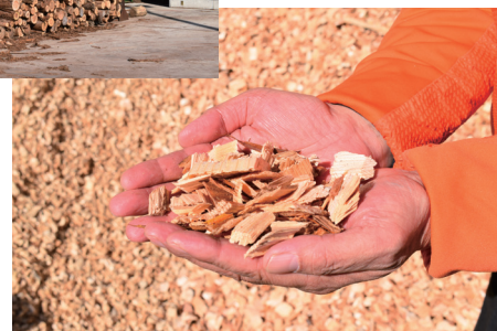
(右)移動式破砕機も活用し木質チップを製造。林地残材をそのまま運びより運搬コストを削減できる。
