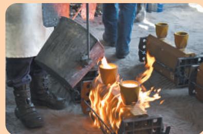
鋳造の様子。約1,200℃の高温で金属を溶かし、冷える前に素早く型に流し込む。
